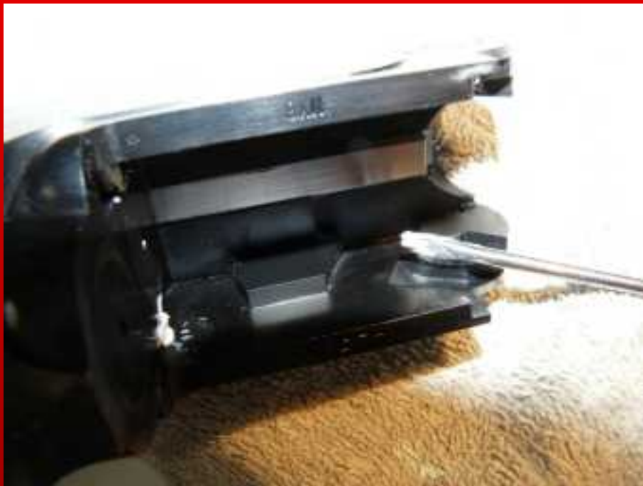
Graissage téflon de l'axe de la bascule.
