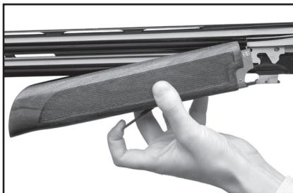
Tirez vers l'extérieur le système de verrouillage du garde-main, puis tournez l'avant du garde-main vers le bas, loin des canons
