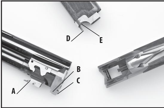
Déposez une ou deux gouttes d'huile dans le logement de l'axe charnière, dans le crochet de fermeture et dans la bride d'attache du garde-main
