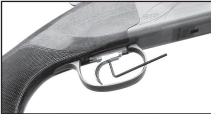
Desserrer la vis centrale sur la queue de détente en se servant d'une clé hexagonale.
