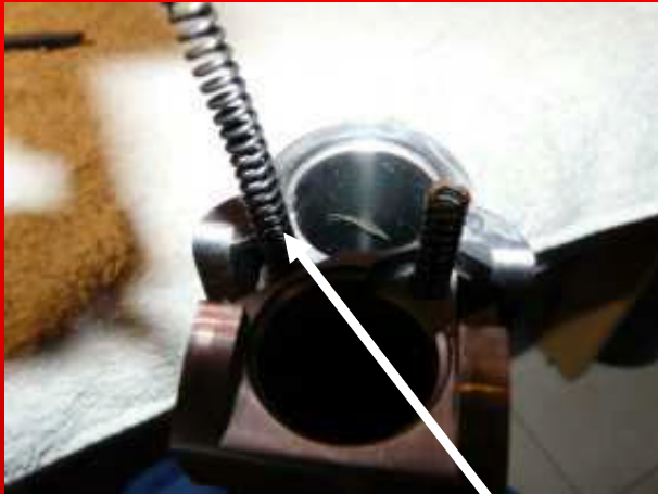
Remontage des ressorts et poussoirs d'éjecteurs
