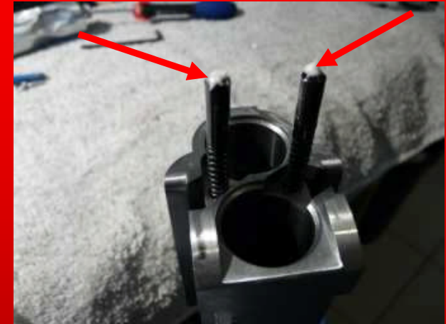
Je mets une pointe de graisse téflon* sur les têtes de poussoir
