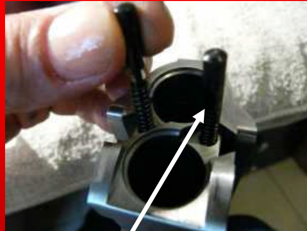
Remontage des ressorts et poussoirs d'éjecteurs
